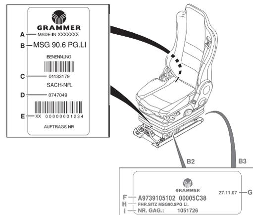
Typenschild für die Auslieferung - ist nicht zur Identifikation geeignet.
